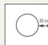
Distance réglementaire de l'isolant et du conduit de fumée raccordé.
